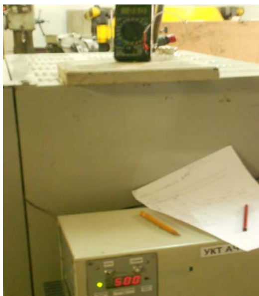
Рис. 4. Фотография сушильного шкафа с цифровым индикатором температуры внутри СКИ «Агат» (вверху снимка, показания температуры 50 °С) и блок цифрового регулирования температуры внутри камеры (показания температуры 500 °С)
