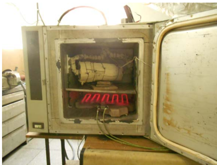
Рис. 3. Фото камеры сушильного электрошкафа СНОЛ-3,5 с установленными ТЭН на 2.5 кВт и СКИ «Агат-222»
